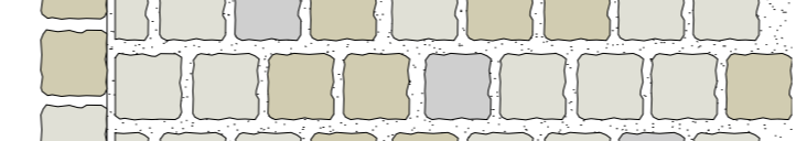
Verlegedetail zu Detail 5/6: Großsteinpflaster - M 1:20
